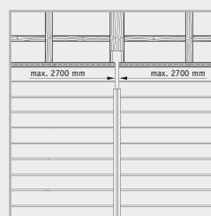
4. Posa orizzontale con giunto verticale, rivestita con profilo di copertura (selekta)
